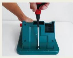
6. バッテリーBOX部分を上から押さえながらプラスドライバーで締めて完成です。
