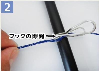
反対側のフックの隙間にも柵線を通して下さい。
