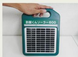
3. 起こした本機の上部を後ろに倒して押すとバッテリーが出てきます。
