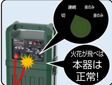
本機のスイッチを連続にしていると、正常であれば火花が飛びます。約1秒間隔で強い火花が飛べば正常です。
