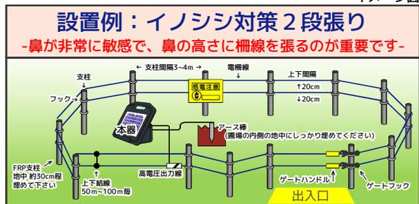
(3段張・支柱間隔4m・出入口1箇所)
