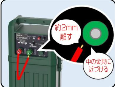
本器マイナス(アース)端子部に出力ケーブル先端を近づける。マイナス(アース)端子に接触させず2mm程度離します。
