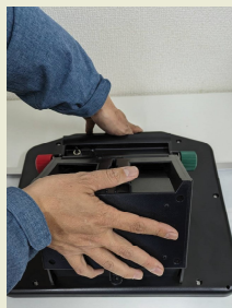
5. 底部(バッテリーBOX)を手で押さえ ながらパネル面を下に倒して下さい。
