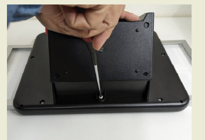
6. バッテリーBOX部分を上から押さえながら ⊕ドライバーで締めて完成です。
